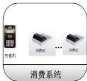
**消费系统:** 智能消费系统采用TCP/IP网络通信方式, 整个系统通过数据中心与原门禁系统数据库服务器进行数据同步, 消费机通过网络与服务器进行实时数据通信, 后台程序自动处理消费数据, 并根据制定的处理流程, 对用户的后台账户进行扣费等相关操作, 并将处理完成的结果返回到消费终端机上, 整个流程对数据进行加密和过滤, 以保证系统稳定、安全, 使用户完全感受不到后台数据处理的过程。
