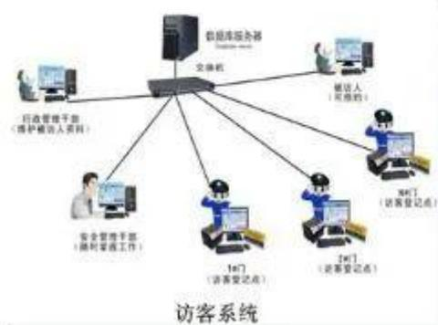
**访客管理系统：**是集软硬件为一体的多功能访客登记一体机，是集计算机技术、射频识别技术、指纹生物识别、触摸屏手写技术、文字识别(OCR)技术、热敏打印技术、条码技术、X射线识别技术、数码摄像技术、自动制证技术、硬件加密技术、网络技术于一体，全面记录、保存来访者来访人员的证件信息、图像信息及进出信息并对来访数据提供便捷的多方式查询，将目前手工填写出入登记管理、电话咨询被访人等传统方式转变为高科技的计算机化、数字化处理，消除了手写登记填写时间长，信息缺失虚假多，不易保存，信息查询困难等种种弊端。
